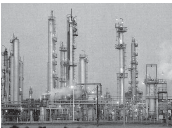
រូបទី3 បំពង់បំណិតប្រេងកាតនេះអាចចិតប្រេងកាតនៅបានរហូតដល់30 000 តោនក្នុងមួយថ្ងៃ ។
